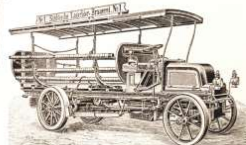
3. Lastwagen mit 12 pferdigem Vierzylindermotor der Daimler-Motoren-Gesellschaft, gebaut für Brauereizwecke.
