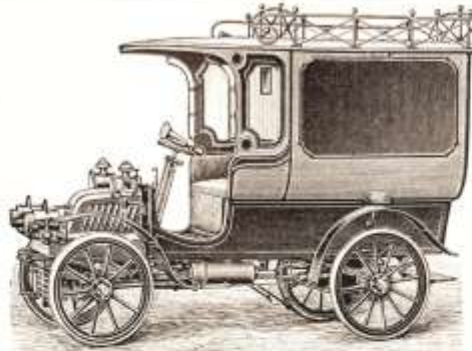
2. Adler-Lieferungswagen mit 24 pferdigem Einzylindermotor.
