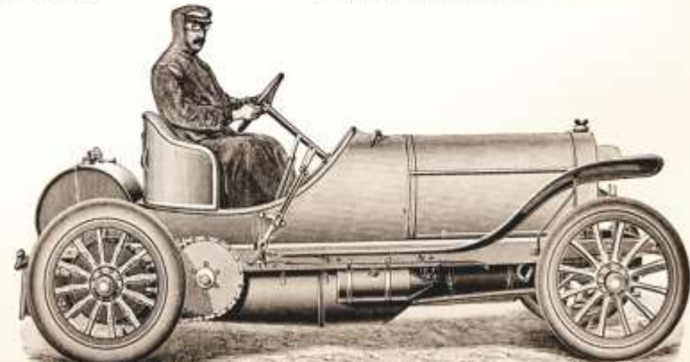
5. Mercedes-Gordon-Bennet-Wagen mit 120 pferdigem Vierzylindermotor, der von Jenatry beim Rennen 1905 in der Auvergne gefahren wurde.
