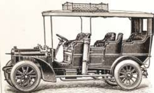
1. Adler-Tonneau, sechssitzig, mit seitlichem Einstieg, Sommerdach und 24 pferdigem Vierzylindermotor.
