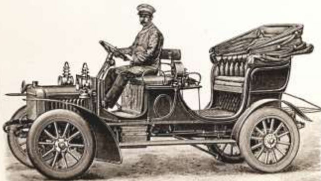
4. Motordroschke mit 12 pferdigem Zweizylindermotor, gebaut von den Adler-Fahrradwerken vorm. Heinrich Kleyer, Frankfurt a. M.
